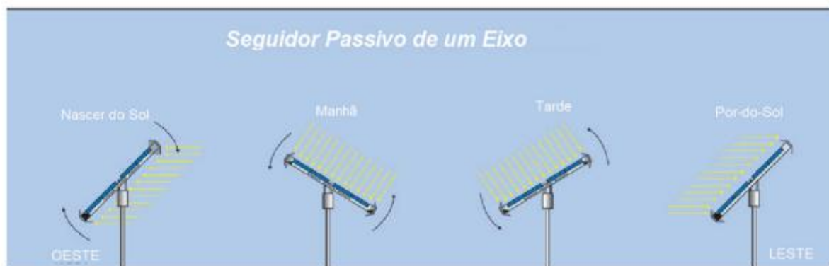
Figura 12 - Ilustração do movimento dos seguidores/rastreadores fotovoltaicos durante o dia.
