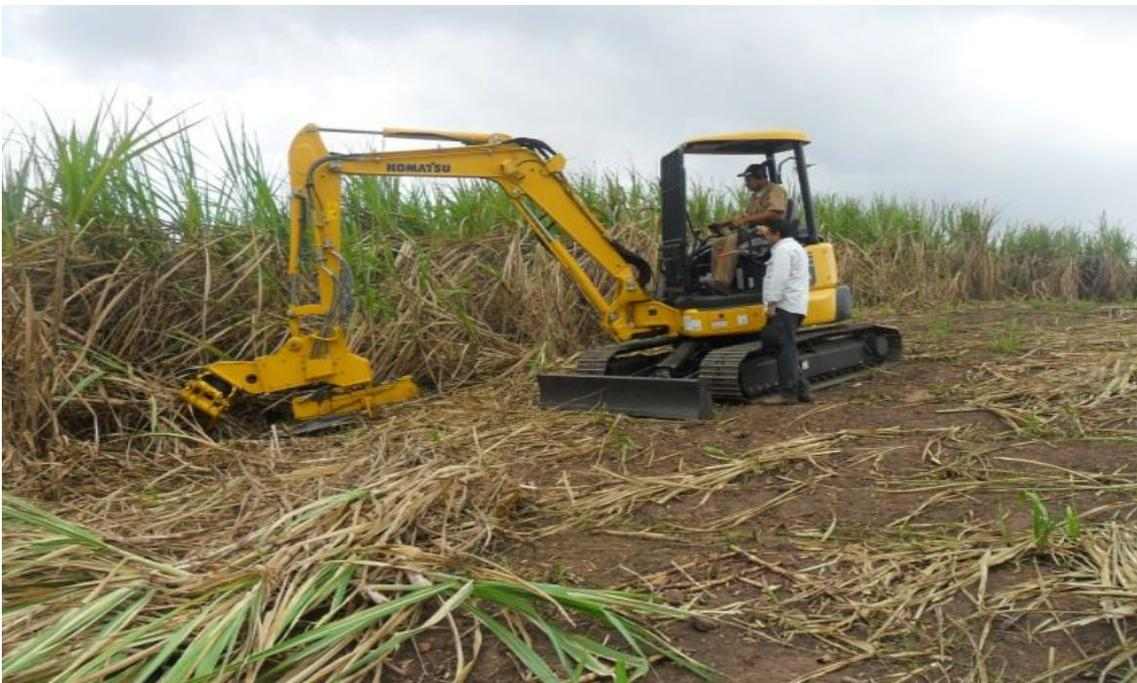
Figura SEQ Figura \\* ARABIC5: Escavadeira Komatsu PCSS com cabeçote Komatsu. Fonte: SINDAÇUCAR, 2017.
