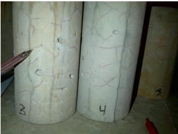
Figura 31: Concreto de 40MPa retirado do forno a 550°C e resfriado ao ar livre.
