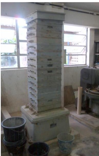
Figura 1: Peneiras para Ensaio de Granulometria da Brita
