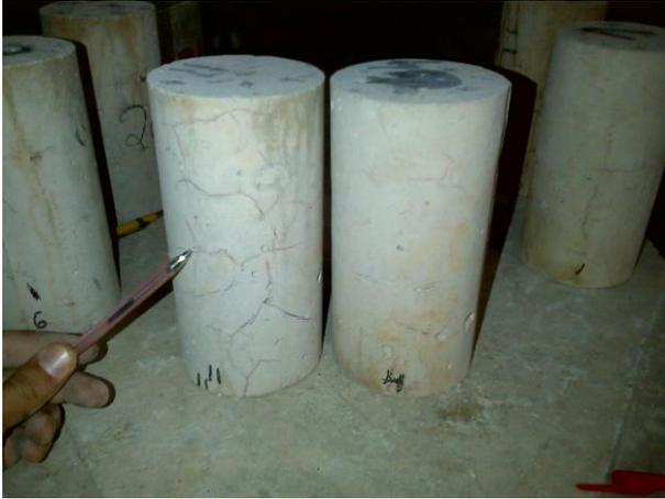
Figura 28: Concreto de 30MPa retirado do forno a 550°C e resfriado ao ar livre.
