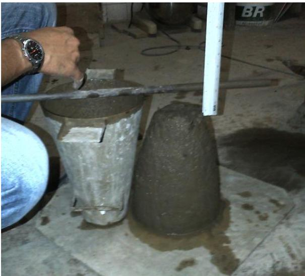
Figura 16: Ensaio “Slump Test” para o Concreto com Fibras de polipropileno.
