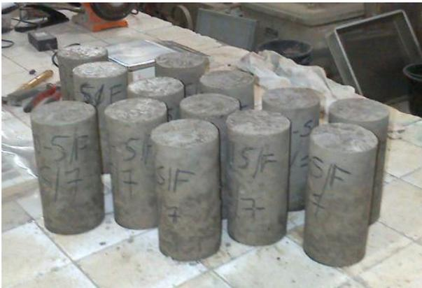
Figura 12: Corpos de Prova Desmoldados
