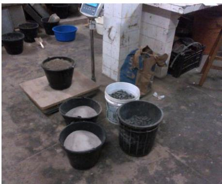
Figura 7: Separação e pesagem de materiais.
