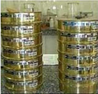
Figura 3: Peneiras para Ensaio de Granulometria da Areia
