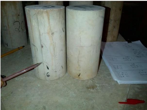
Figura27: Concreto de 30MPa retirado do forno a 450°C e resfriado ao ar livre.
