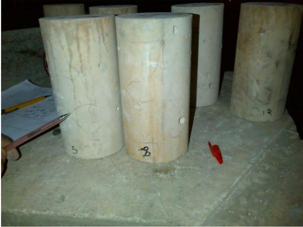
Figura 30: Concreto de 40MPa retirado do forno a 450°C e resfriado ao ar livre.
