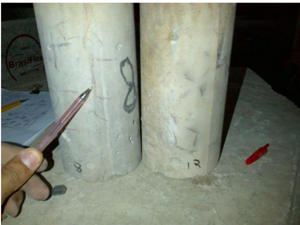
Figura 29: Concreto de 40MPa retirado do forno a 350°C e resfriado ao ar livre.
