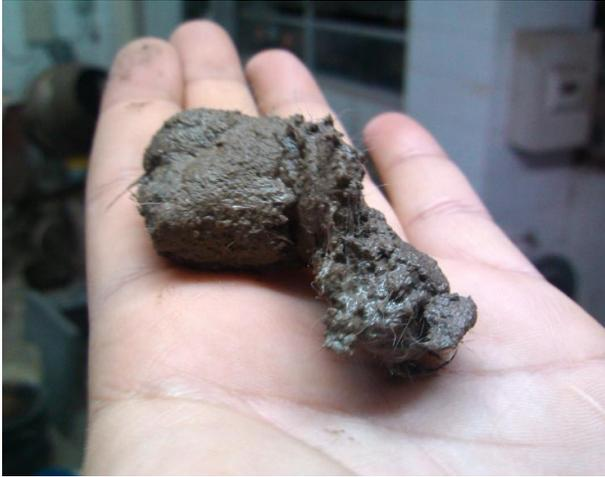
Figura 15: Concreto com Adição de Fibras
