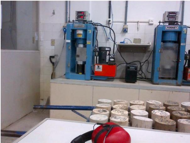
Figura 33: Prensas utilizadas nos ensaios de ruptura a compressão axial
