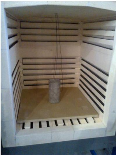
Figura 19– Corpo de Prova monitorado dentro do Forno
