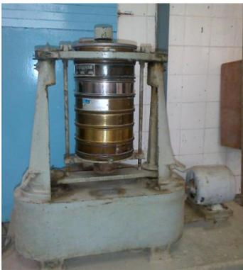
Figura 4: Equipamento utilizado para o peneiramento
