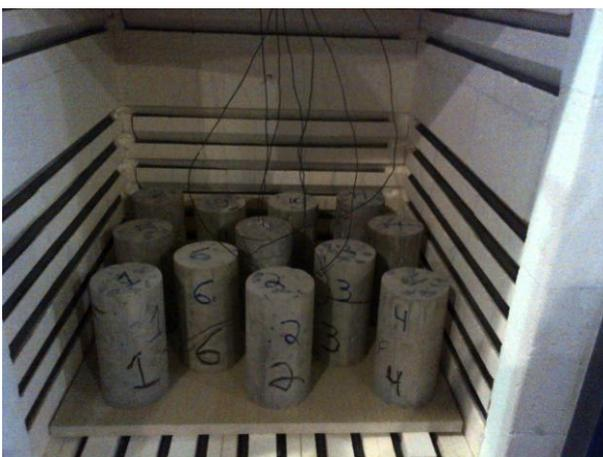
Figura 20 – Todos os Corpos de Prova dentro do Forno
