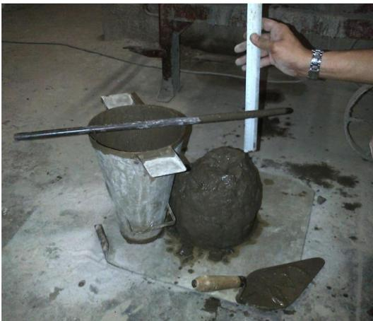
Figura 9: Ensaio “Slump Test”
