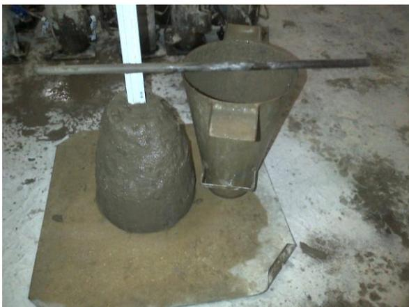
Figura 13: Ensaio “Slump Test”
