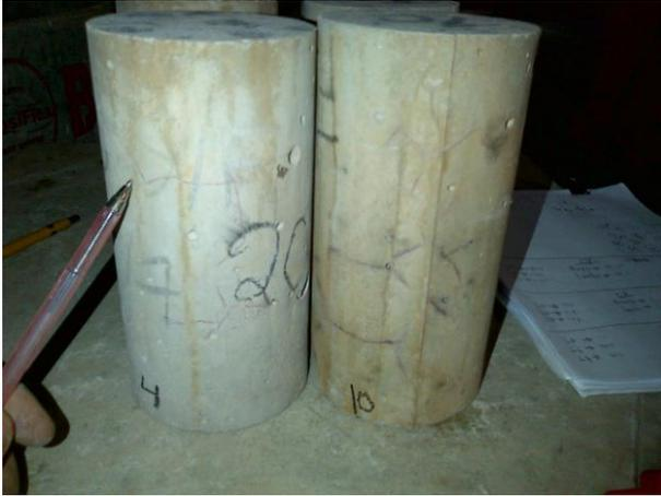
Figura 26: Concreto de 30MPa retirado do forno a 350°C e resfriado ao ar livre.
