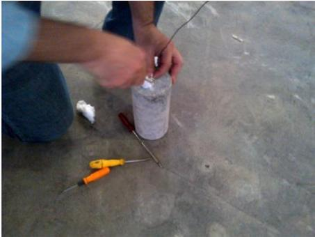
Figura 18 – Colocando material isolante ao redor do termopar
