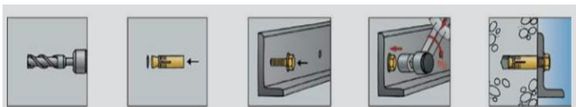
Figura 2.5 – Chumbador de Expansão Jaqueta e Cone (Fisher).
