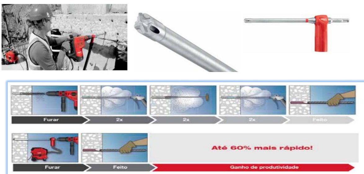
Figura 2.18 – Broca com sistema de extração de pó e procedimento de instalação (Hilti).
