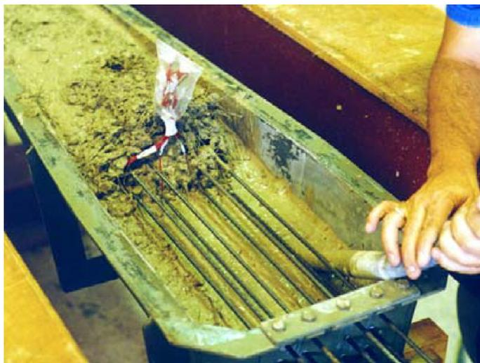
*Foto 1 - Preenchimento de forma com concreto aderente à armadura - Fonte: <http://dc341.4shared.com/doc/fzWPsY2B/preview.html>*
