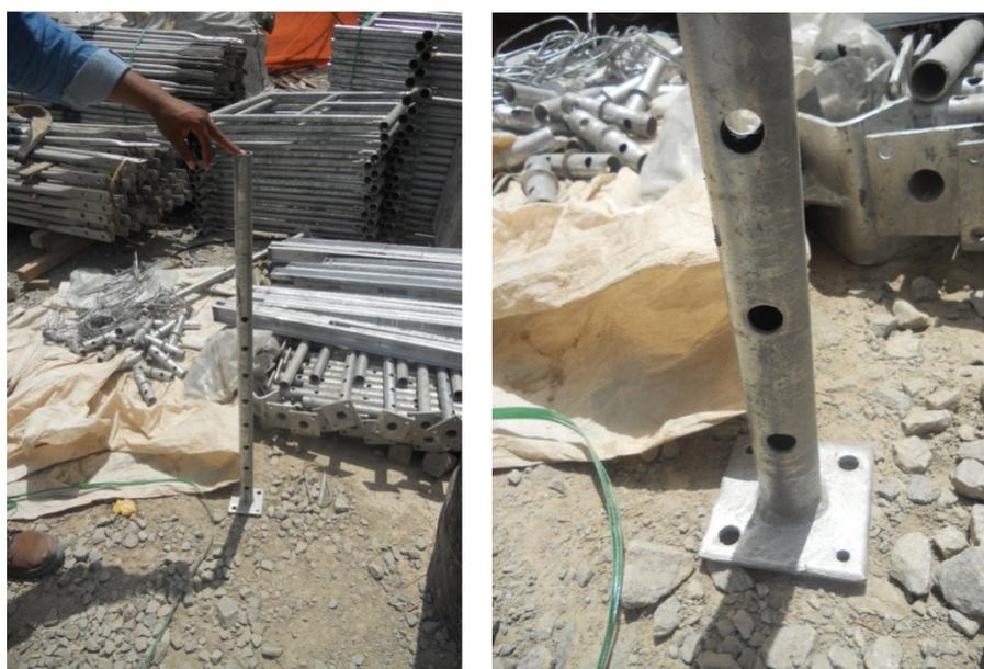
Figura 11 - Detalhes dos furos na corneta
