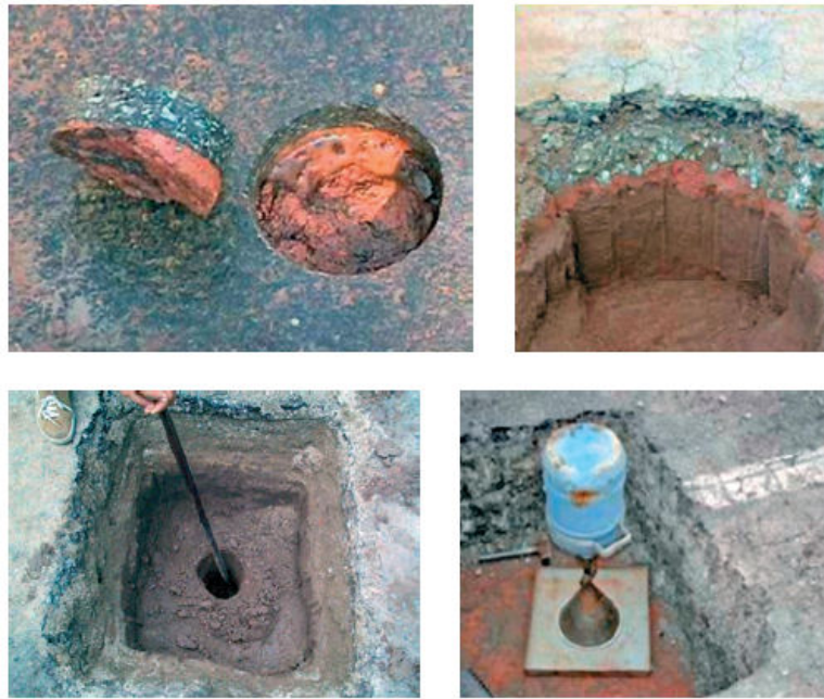
Figura 7. Exemplos de extração de corpos de prova e de poços de sondagem em pavimentos em uso (BERNUCCI et al, 2010)
