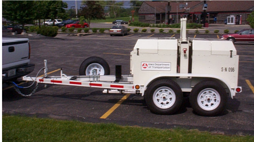
Figura 9 - Deflectômetro de impacto FWD.
