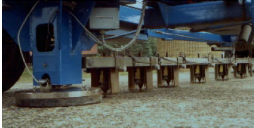
Figura 10. Sensores de medida de deflexão (MACEDO, 2003).
