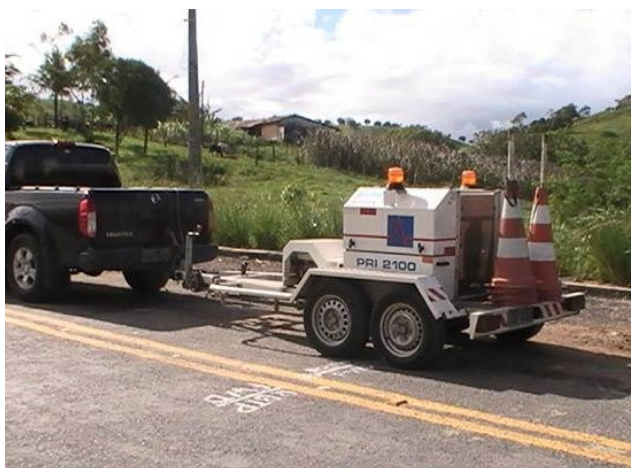
Figura 12 - Equipamento FWD (PRI 2100 FWD) utilizado no levantamento do trecho (Km 42 + 4,0m a Km 50 + 10,0m)
