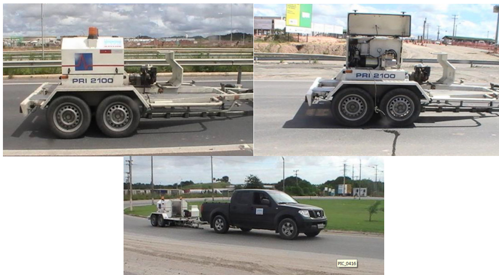
Figura 3.2: Fotos do equipamento usado no levantamento deflectométrico.
