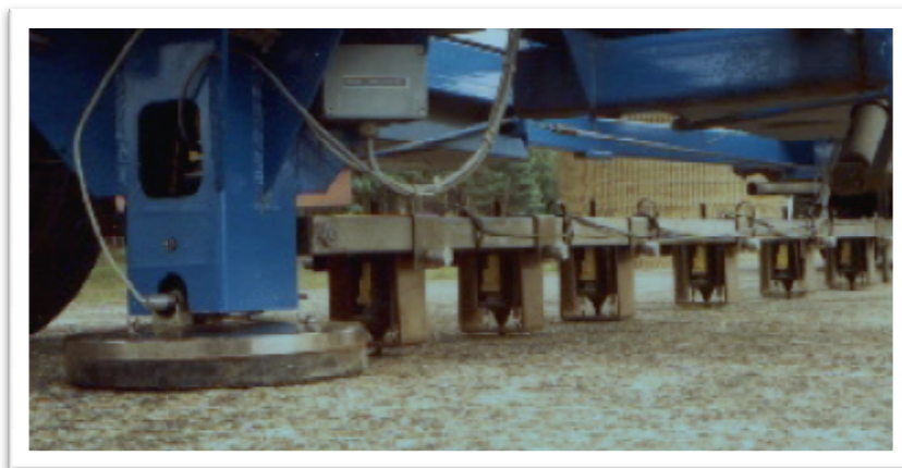
Figura 2.11: Sensores de medida de deflexão (MACEDO, 2003)
