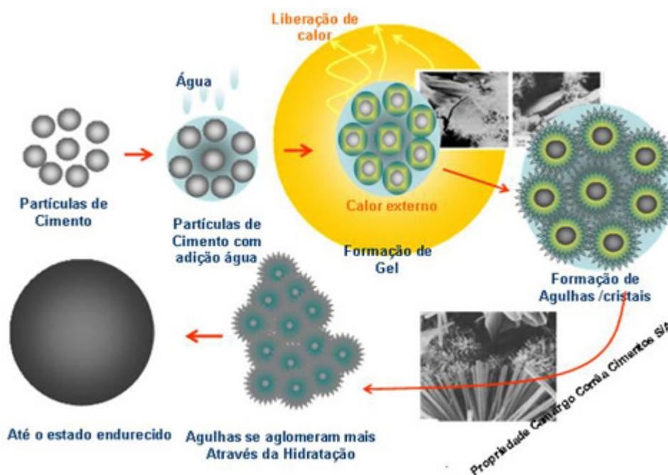
Figura 13- Reação de hidratação do cimento (Fonte: Aragão, 2007)
