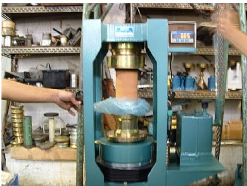
Figura 17- Prensa hidráulica para rompimento dos corpos de prova
