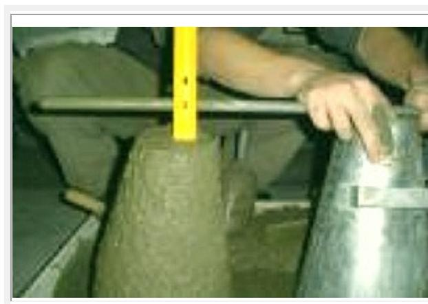
Figura 14- Ensaio de abatimento do concreto
