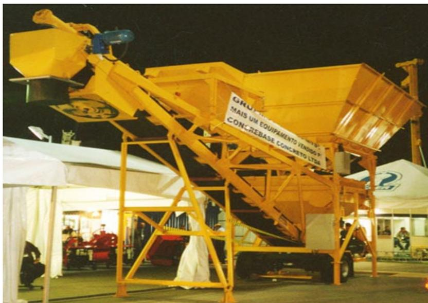
**Figura 3- Caixa e balança de agregados**
