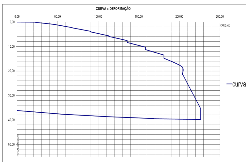
Figura 4.8- Curva Carga x Recalque
