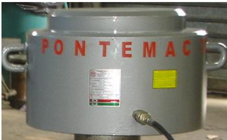
Figura 3.1- Macaco hidráulico com capacidade de 700 tf
