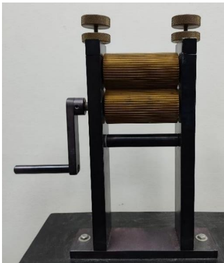
Figura 9 - Equipamento utilizado na construção dos canais longitudinais e paralelos dos Monolitos de Fecralloy.
