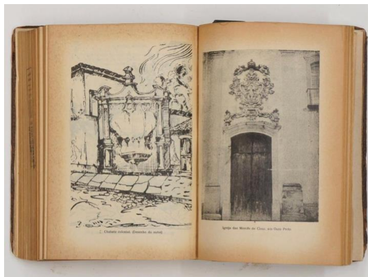
Figura 09 - Amarelecimento do papel por reação fotoquímica (BOJANOSKI e ALMADA, 2021, p. 21)
