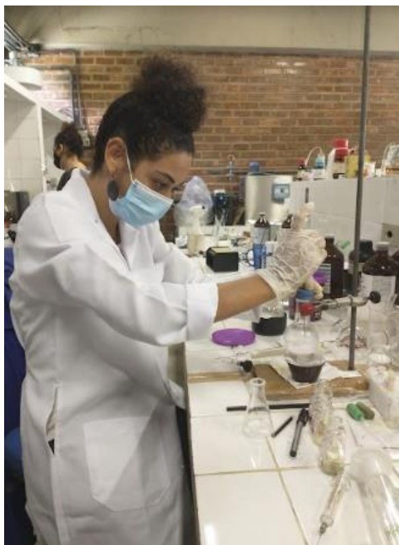
Figura 19 - Lavagem manual da água-mãe contendo íons cloreto e sódio após decantação do precipitado.
