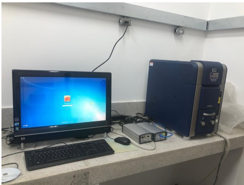
Figura 14 - Microscopia Eletrônica de Varredura (MEV) com Espectroscopia por Energia Dispersiva (EDS) de bancada Hitachi (INTM/UFPE).
