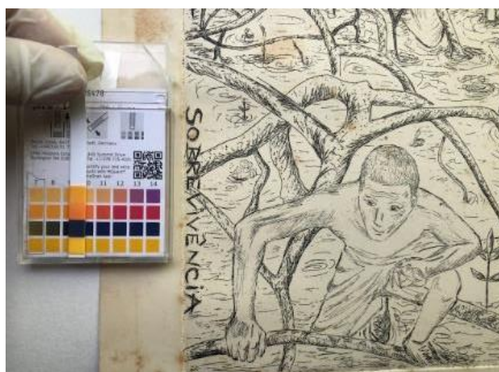
Figura 26 - Medição do pH pós-tratamento de desacidificação com dispersão de nanopartículas de hidróxido de cálcio em etanol.
