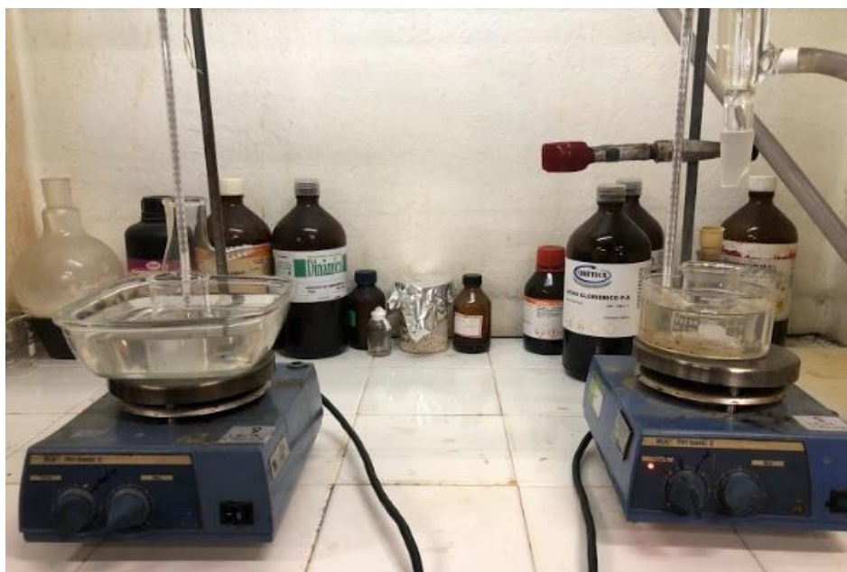
Figura 15 - Preparação das soluções de hidróxido de sódio e cloreto de cálcio.
