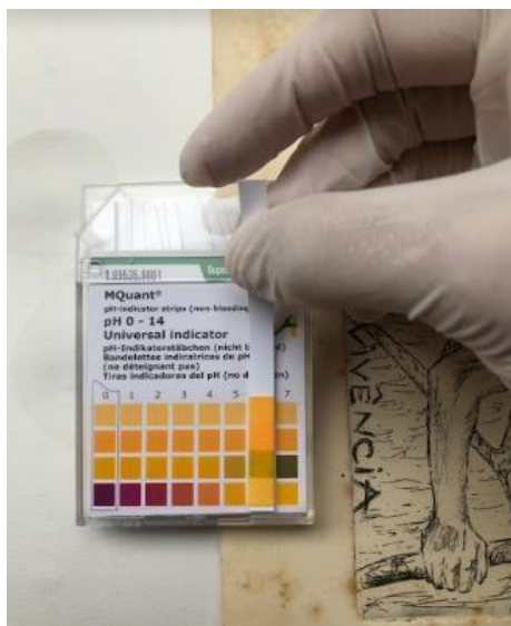
Figura 24 - Medição do pH da gravura antes do tratamento de desacidificação.
