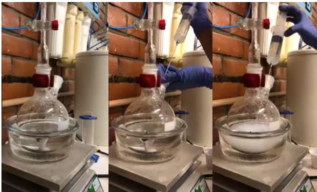
Figura 16 - Introdução em etapas dos reagentes: início da reação de síntese de nanopartículas de hidróxido de cálcio.
