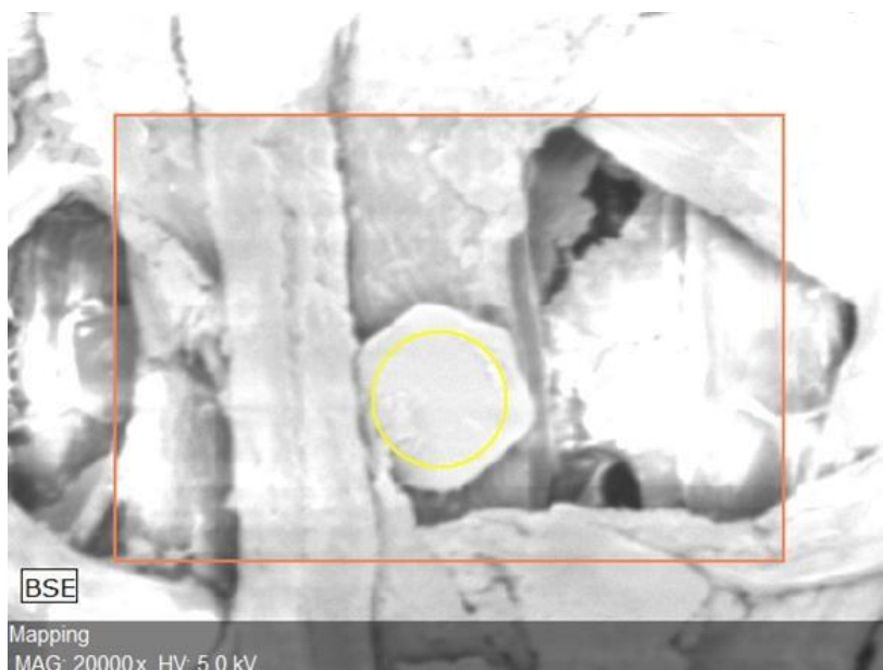
Figura 27 – Imagem do produto entre fibras de celulose. Reconhecimento pelo formato hexagonal.
