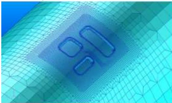
(c) Malha de elementos finitos para colônia de defeitos retangulares
