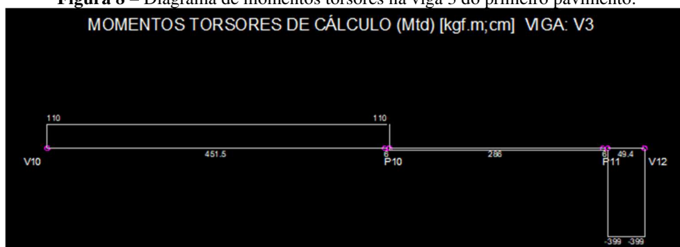
Figura 8 – Diagrama de momentos torsores na viga 3 do primeiro pavimento.
