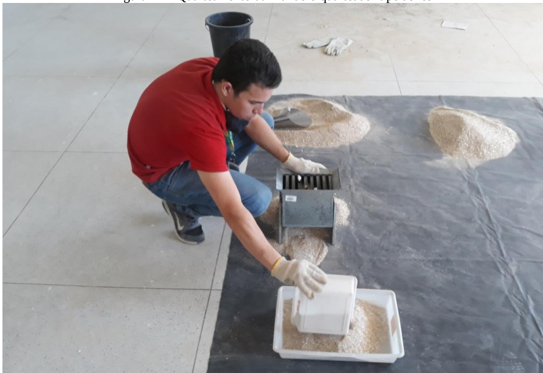
Figura 17 – Quartejamento utilizando o quarteador tipo Jones
