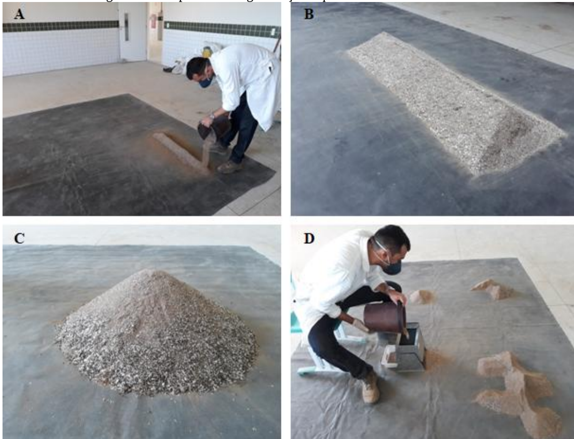
Figura 18 – Etapas de homogeneização e quartearamento dos tratamentos
