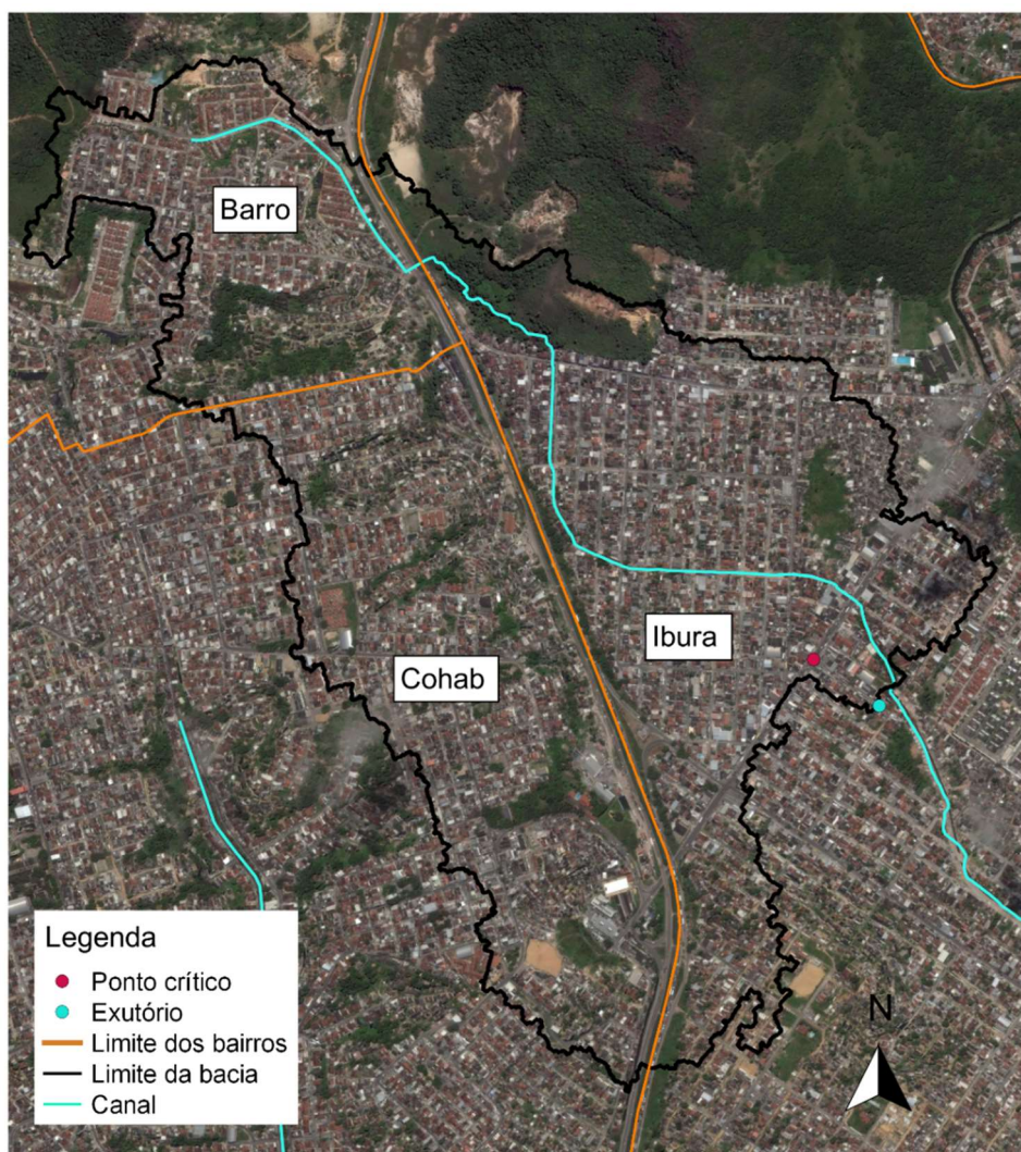
Figura 10 Detalhe da área de contribuição para o ponto crítico de alagamento
