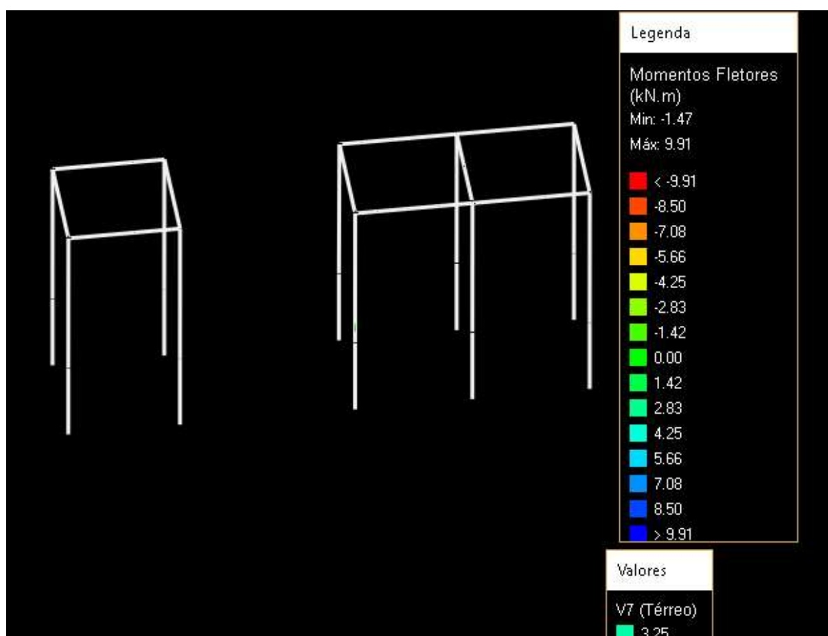
Figura – 15 Pórtico no formato de barras e legenda indicativa dos valores de momentos fletores
