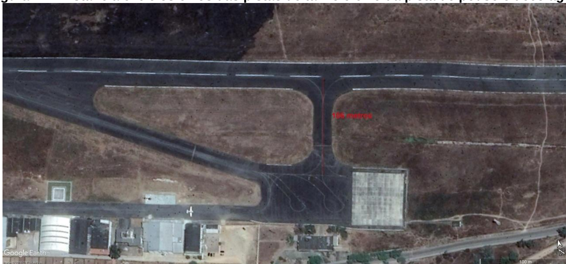
Figura 24 - Distância entre os eixos das pistas de táxi e o eixo da pista de pouso e decolagem
