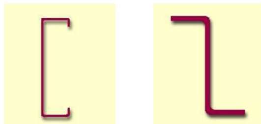
Figura 16: Perfis de chapa dobrada, os quais são cobertos pela NBR-14762:2010.
