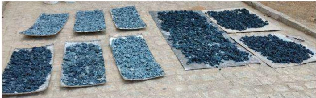
Figura 8 - Lodo secando ao ar livre.
