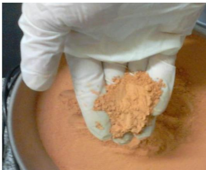
Figura 13 - Cerâmica vermelha após moagem.
