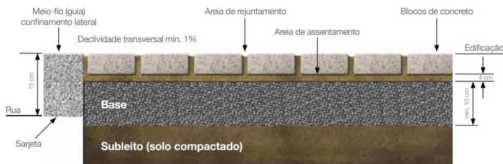
Figura 3 - Seção transversal da aplicação dos pavers.
