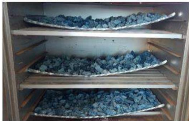
Figura 9 - Lodo secando em estufa.
