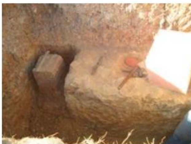
Figura 12 - Modelagem de amostra indeformada tipo bloco.
