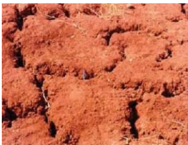
Figura 1 - Fissuras e microrrelevos do solo na estação seca, solo expansivo de Petrolândia.
