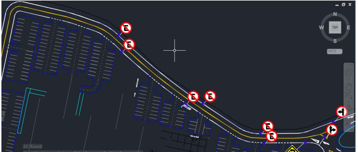
Figura 56 – Projeto de sinalização regulamentando o estacionamento em diversos trechos
