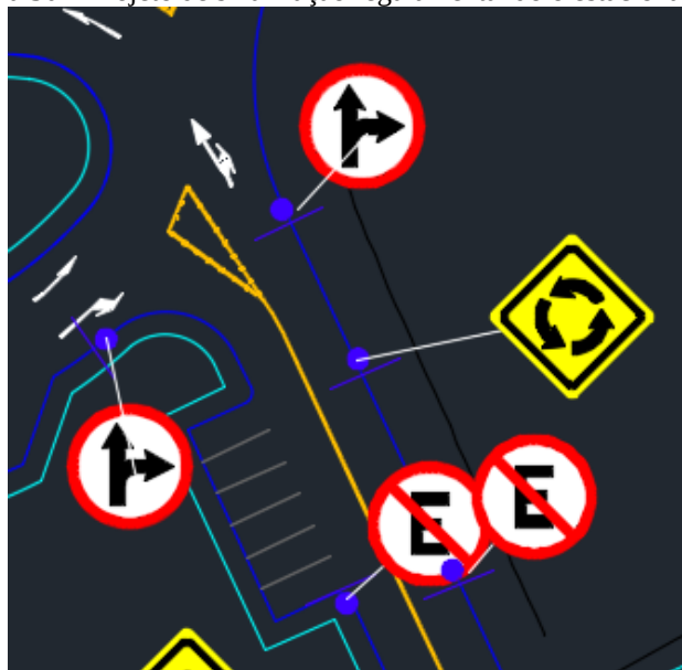
Figura 50 – Projeto de sinalização regulamentando o estacionamento
