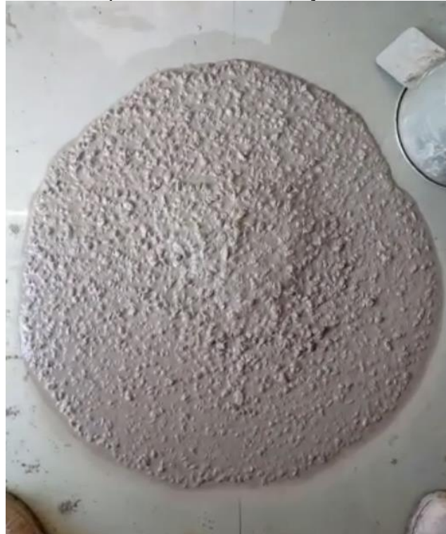
Figura 8 – Vista do espalhamento com traço de fíler calcário (100F).
