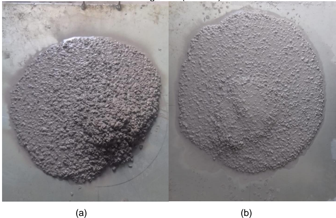
Figura 9 - Vista dos espalhamentos com substituição parcial por cinza da lenha de algaroba (50F50C).
