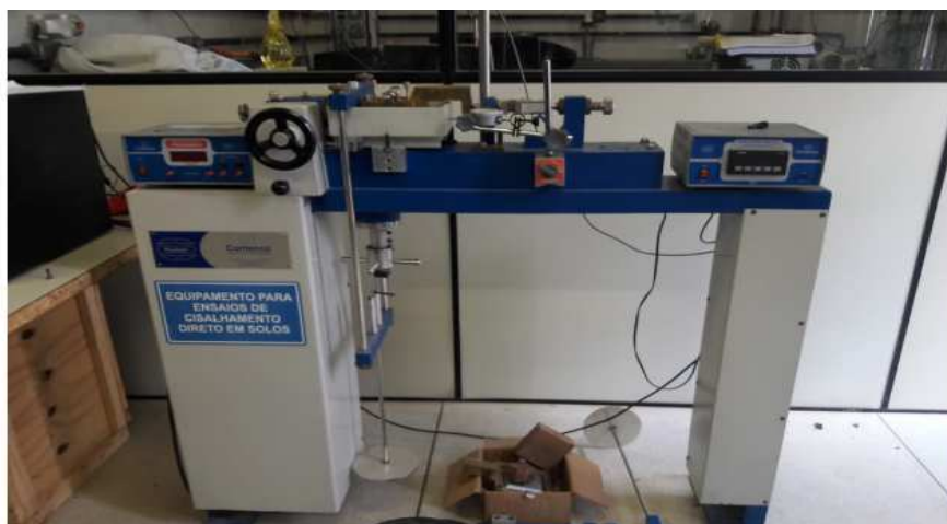
Figura 16 - Aparelho de ensaios de Resistência ao Cisalhamento Direto
