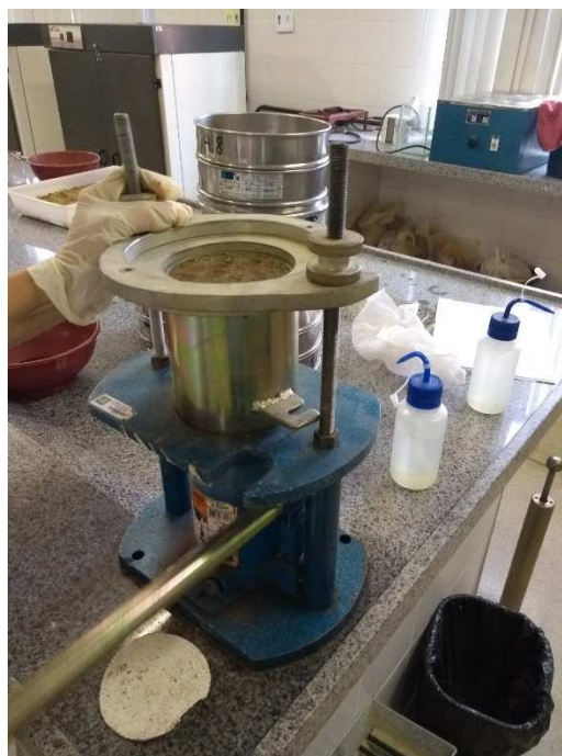
Figura 15 - Corpo de prova sendo retirado do cilindro no extrator de amostras.
