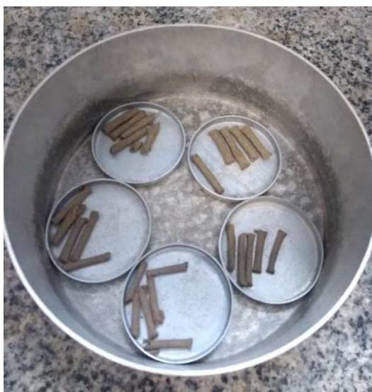
Figura 12 - Cápsulas de alumínio contendo amostras de solo do ensaio de limite de plasticidade já após as 24 horas na estufa a 105°C
