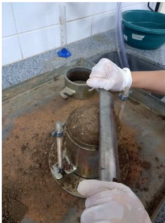
Figura 14 - Corpo de prova sendo preparado para ser pesado junto com o cilindro.
