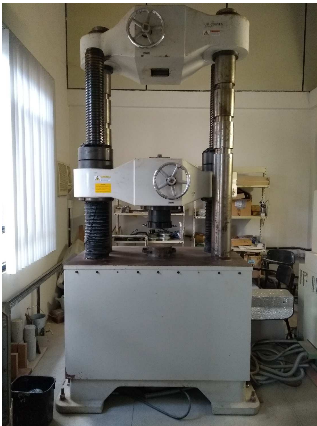
Figura 21 - Prensa universal de 2.000 kN utilizada no ensaio.
