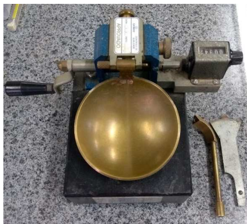
Figura 9 - Aparelho de Casagrande com cinzéis utilizados no ensaio
