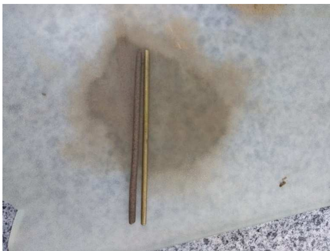
Figura 11 - Amostra de solo e gabarito do ensaio de limite de plasticidade.
