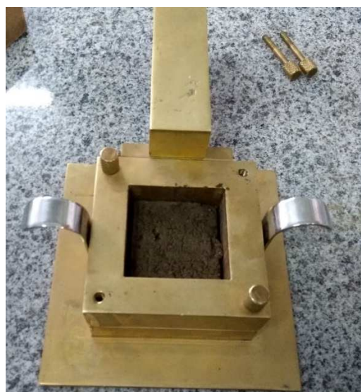
Figura 17 - Corpo de prova confinado na caixa de cisalhamento.
