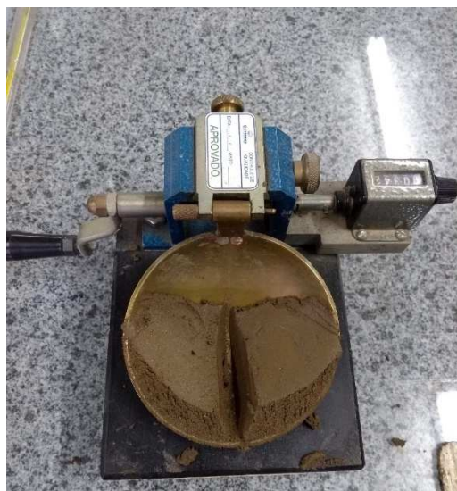
Figura 10 - Ranhura do solo durante ensaio de limite de liquidez
