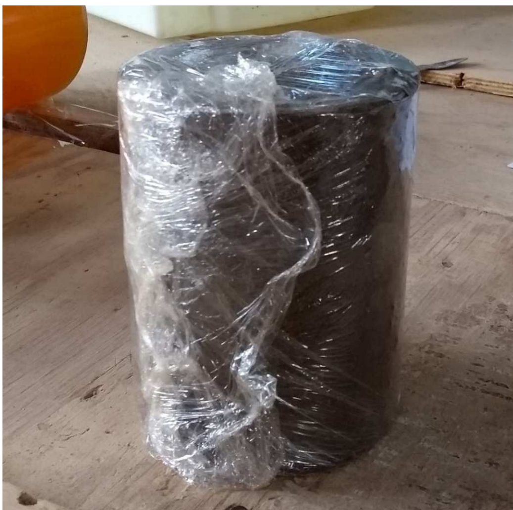
Figura 20 - Acondicionamento dos corpos de prova com plástico filme.
