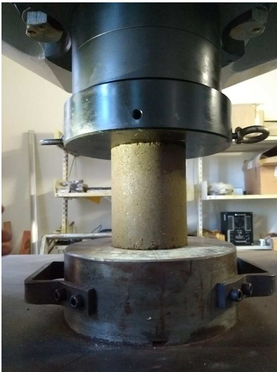
Figura 22 - Corpo de prova em processo de compressão pela prensa universal.
