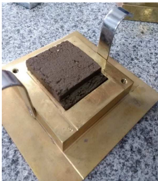
Figura 19 - Corpo de prova após sofrer o cisalhamento.
