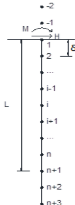
Figura 11 – Esquema da estaca em função da profundidade
