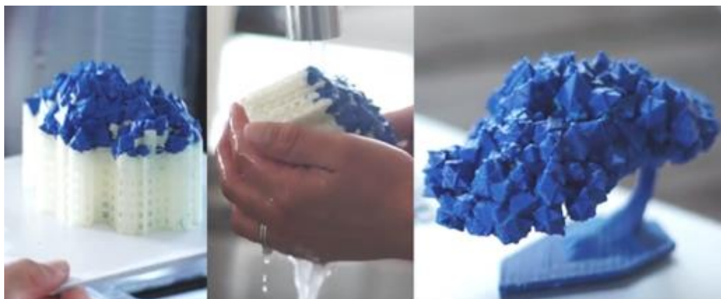
Figura 22 - Objeto conformado em FDM com projeção de suporte na cor branca - Fonte: 3DPRINT, 2015.
