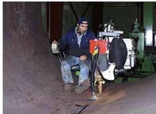
(b) Soldagem da chapa conformada.
