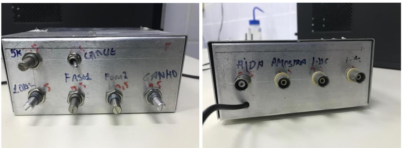
**Fig. 3.7:** Painel frontal com os potenciômetros e as chaves, e painel traseiro com as entradas para alimentação, de corrente AC, corrente DC e da amostra.
