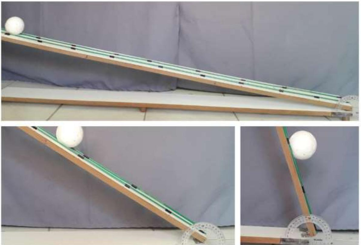
Figura 11: Procedimento experimental para os ângulos de 10°, 40° e 80°. Fonte: Autor, 2019.
