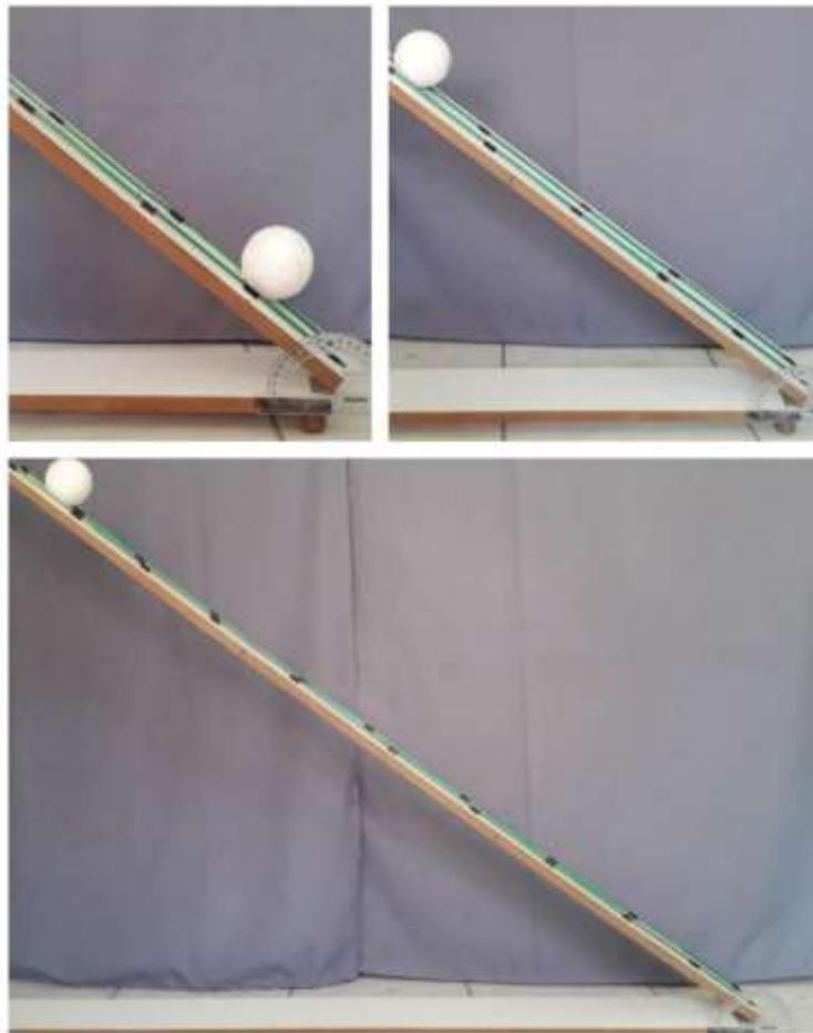
Figura 8: Procedimento experimental para alturas de  $h=10$  cm,  $h=50$  cm e  $h=100$ cm. **Fonte: Autor, 2019.**
