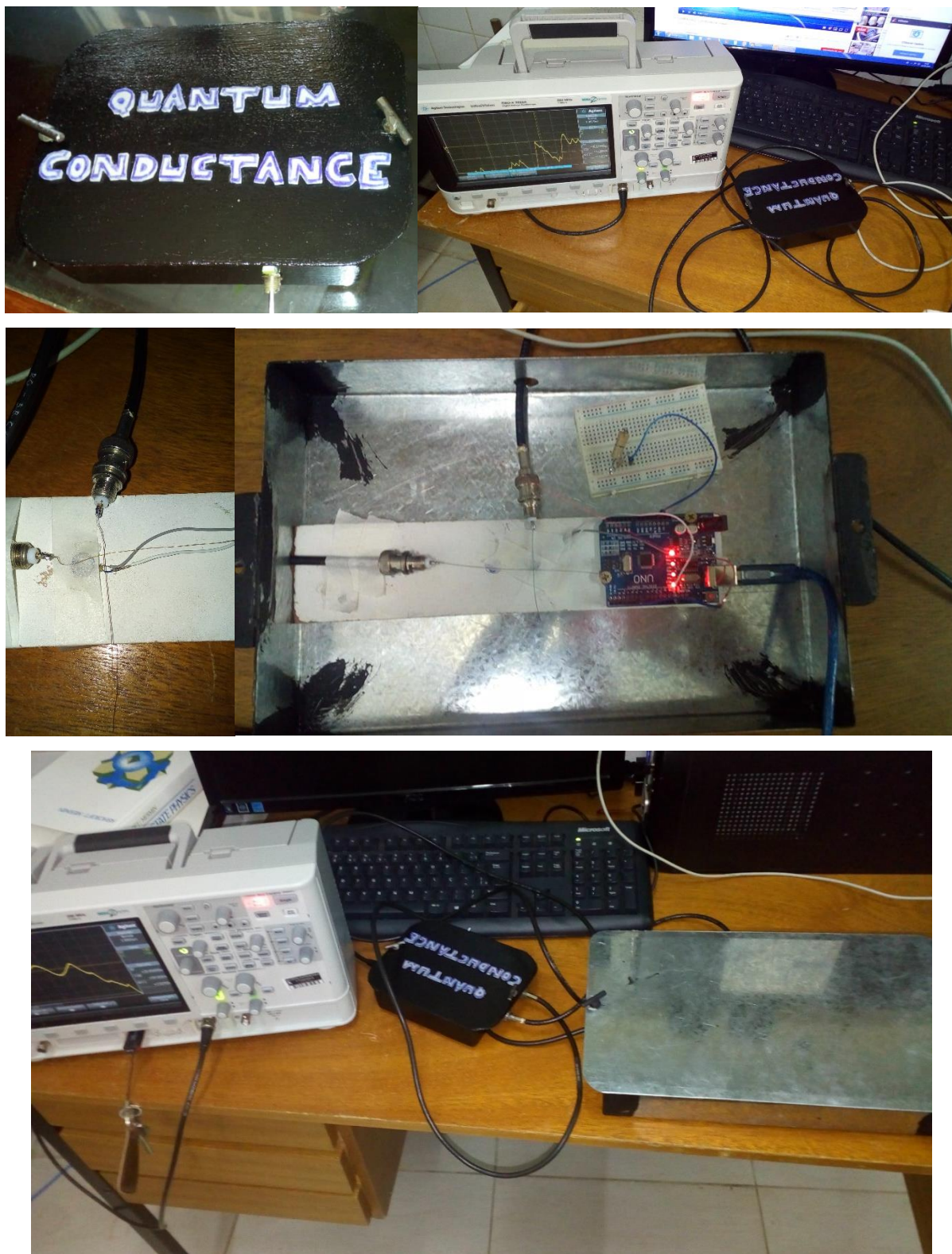
Figura 37 - Fotos do experimento. Podemos ver a caixa do circuito elétrico, a caixa onde os fios ficavam oscilando junto com o micromotor. A última foto é a montagem experimental completa.
