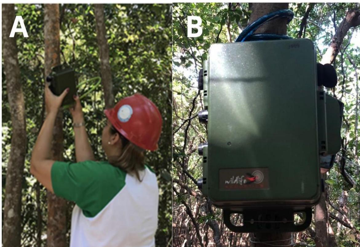
**Figura 5.** A- Pesquisadora instalando o gravador em campo. B- Gravador autônomo SM4 (Wildlife acoustics) instalado em uma das áreas de estudo.
