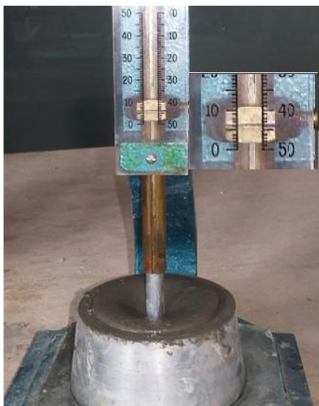
Figura 7: Determinação da pasta de consistência normal
