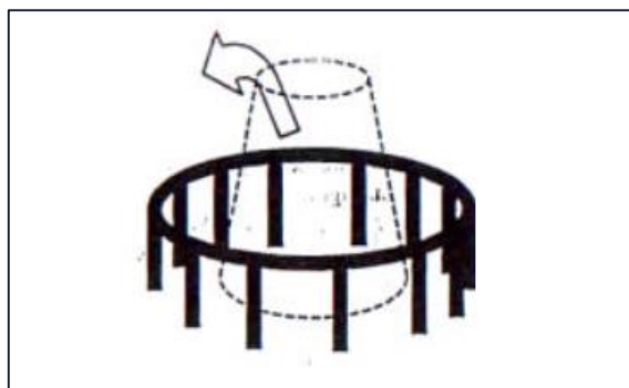
Figura 17 - Anel J e cone de Abrams. FONTE: EFNARC (2002).
