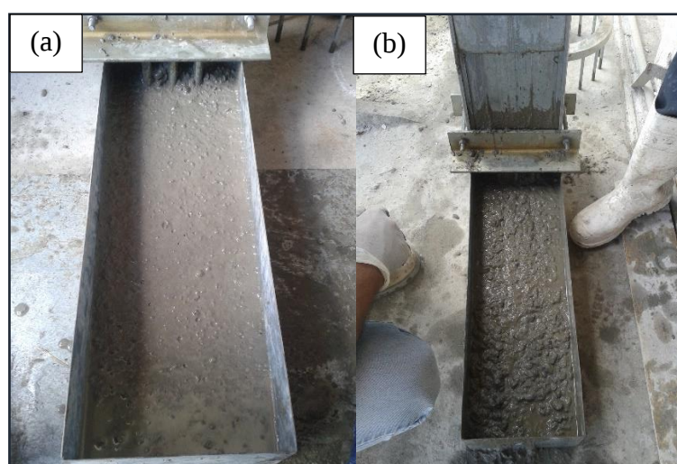
Figura 40 - Ensaio de caixa L. (a) Ensaio de caixa L para o CAA de Referência, (b) Ensaio de caixa L para o CAA alternativo. FONTE: O autor (2018)
