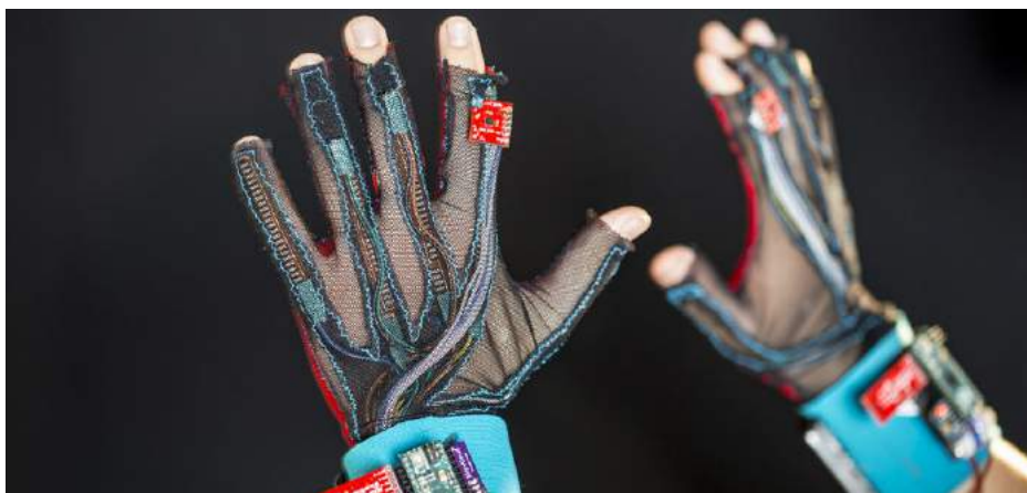
Figura 6 – Abordagem de captura de mão usando usando uma luva
