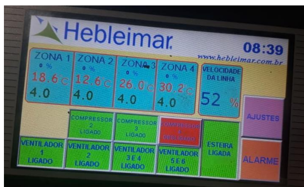
Figura 7: Imagem das temperaturas das zonas do túnel de resfriamento.
