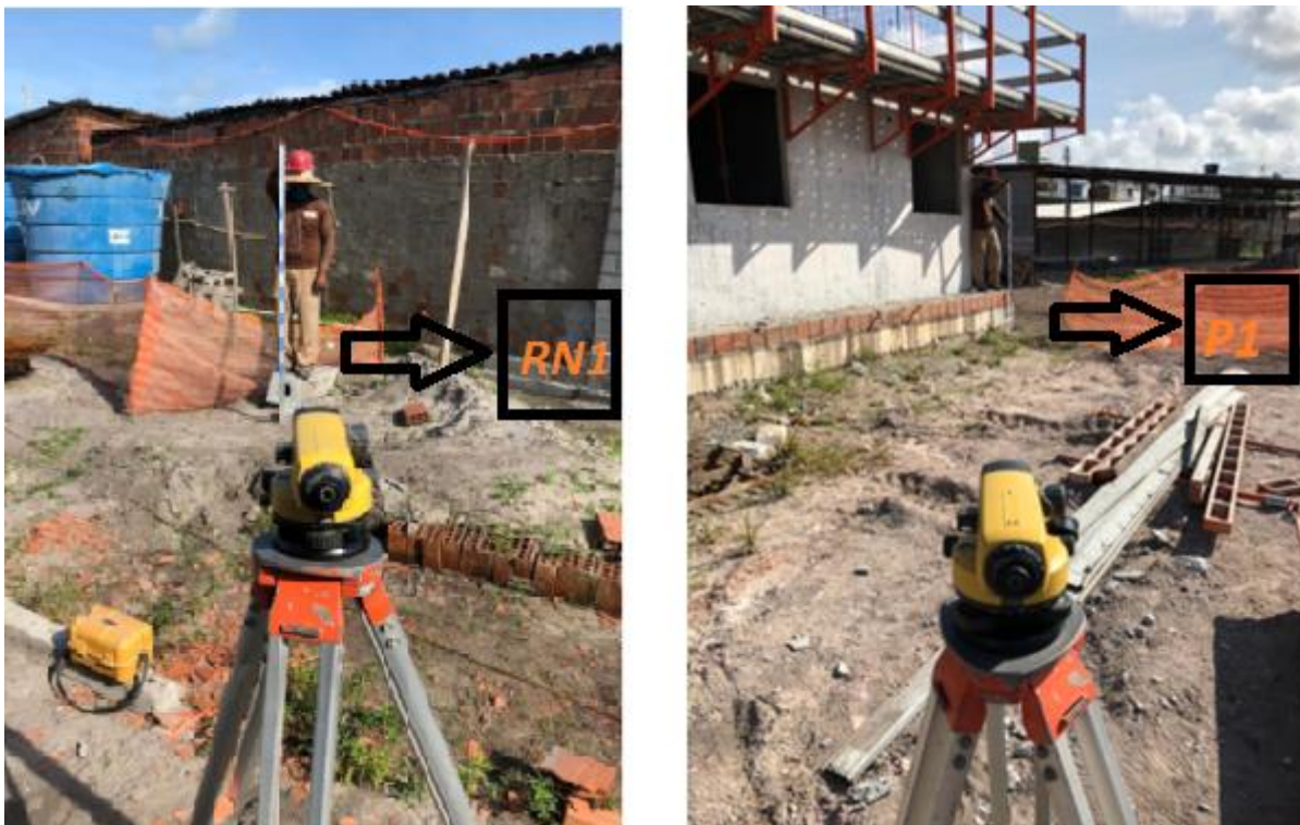
Fotografia 8 - Localização da instrumentação de monitoramento: (a) Ponto de referência indeslocável RN1; e (b) Ponto de referência deslocável P1
