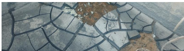
Figura 7: Coleta do lodo em seu leito de secagem
