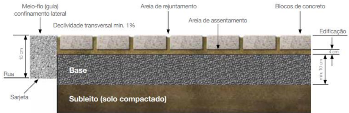
Figura 3: Seção transversal do pavimento intertravado
