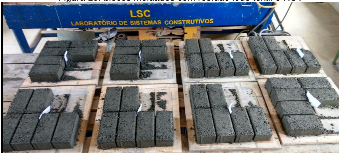
Figura 10: blocos moldados com resíduo lodo têxtil e RCV
