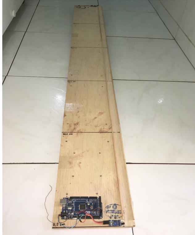
Esta placa Arduino consegue realizar medidas para o intervalo de tempo de maneira automatizada, como exemplificado na figura abaixo (Figura 8). O código executado na placa MEGA reúne informações de 50 lançamentos consecutivos e calcula a média aritmética desses valores.
