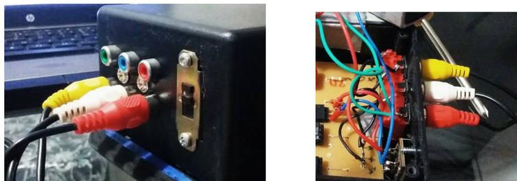
Figura 17 – Cabos utilizados para transmissão de sinais.
