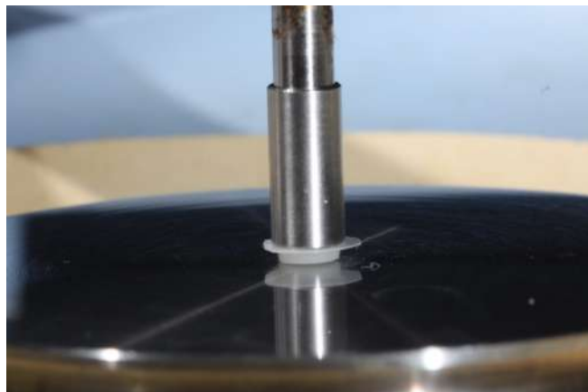
Figura 15: Amostra de cimento posicionada sobre o cristal da ATR.
