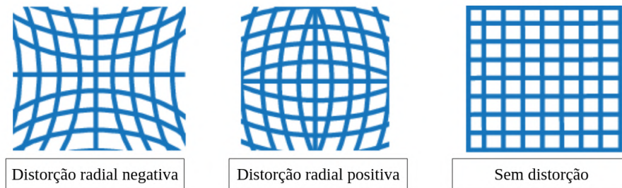
Figura 8 – Tipos de distorções radiais: (a) negativa e (b) positiva. Por fim, (c) mostra a lente ideal sem distorções.
