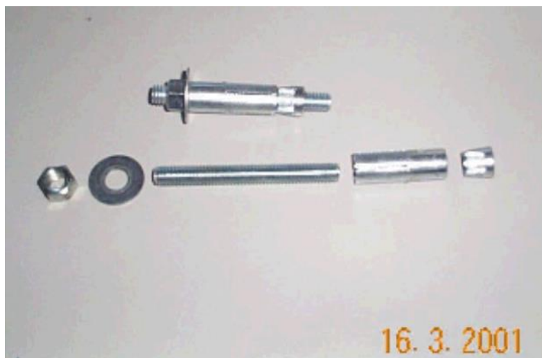
Figura 10 – Detalhe de pino de recalque utilizado em Recife.
