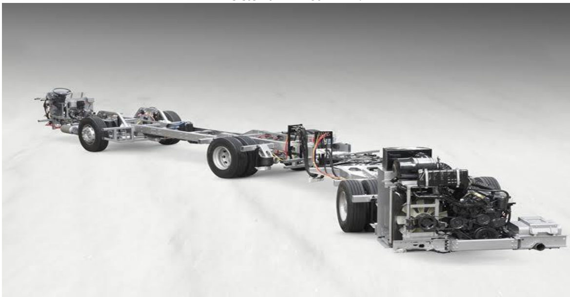
Figura 56 - Configuração de eixos dos ônibus articulados que operam no Corredor Leste-Oeste do sistema BRT da RMR.
