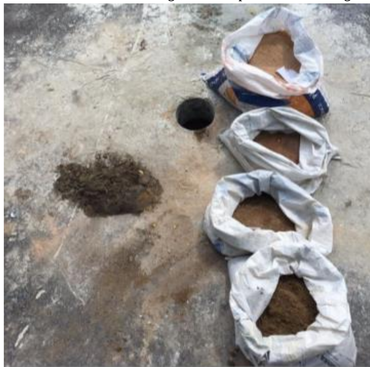
Figura 77 - Material granular da camada de sub-base e do subleito do pavimento de concreto de cimento Portland da avenida Caxangá, extraído por meio de sondagem a trado.
