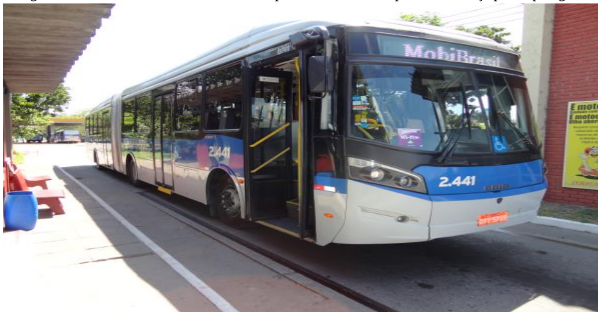
Figura 63 - Ônibus do corredor Leste/Oeste posicionado sobre o prato da balança para a pesagem.
