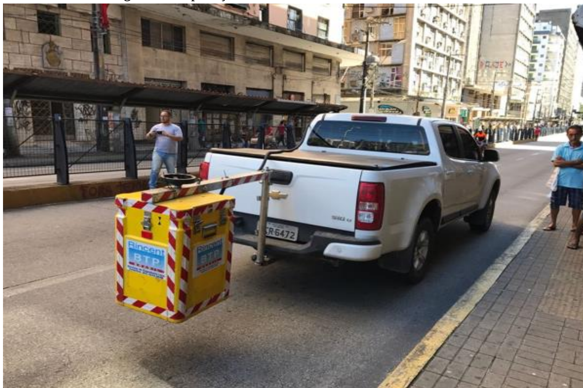
Figura 70 - Aplicação do Euradar na avenida Conde da Boa Vista.
