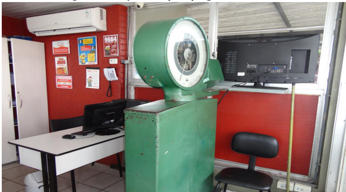
Figura 59 - Balança utilizada para a pesagem de eixos de veículos.
