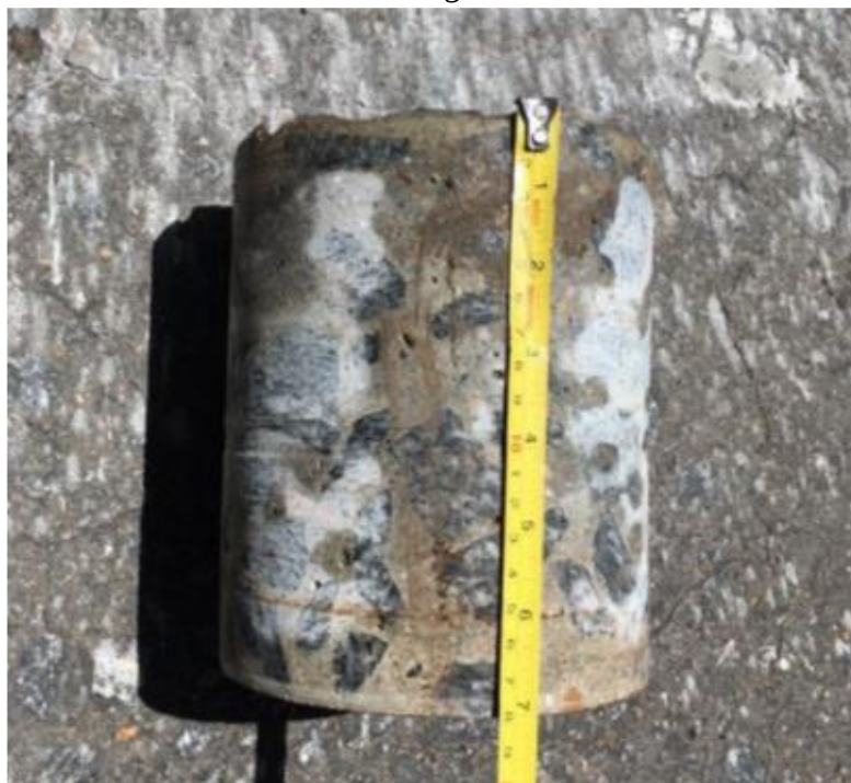
Figura 76 - Testemunho extraído de placa de concreto de cimento Portland da avenida Caxangá por meio de sondagem rotativa.
