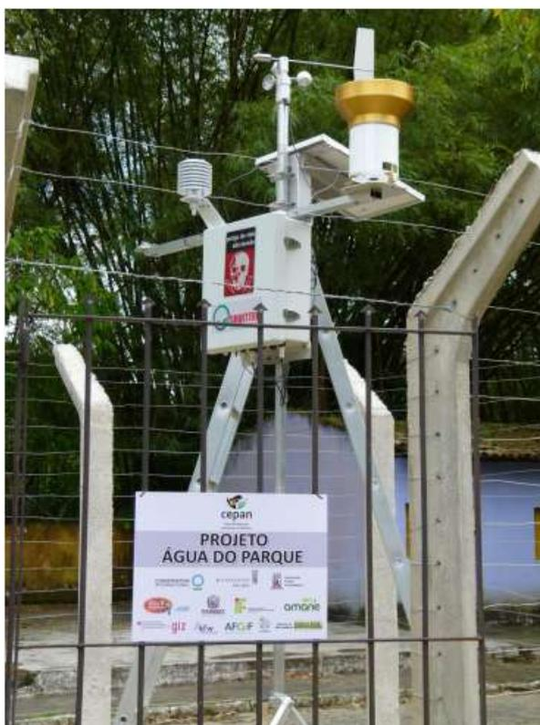
Figura 11 – Plataforma de coleta de dados da Squitter ambiental, modelo completo S1000.
