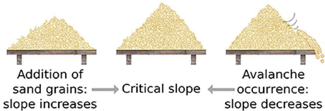
Figura 2 – O modelo de pilha de areia é um modelo clássico para estudar o conceito de criticidade auto-organizada. Grãos de areia são adicionados continuamente a uma taxa fixa sobre uma superfície plana. Uma pilha de areia se forma. Conforme a areia é adicionada, a inclinação da pilha aumenta e avalanches de grãos de areia começam a ocorrer. Se a inclinação ultrapassar um “ângulo crítico”, através de avalanches de qualquer tamanho diminuirão a inclinação de modo que volte para perto da inclinação crítica.
