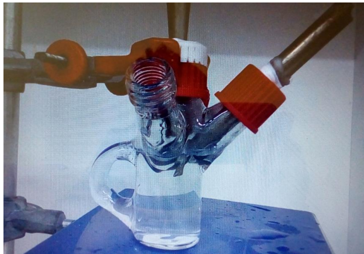
Figura 8 - Célula eletroquímica de 4 vias com aleta usada nas reações de HSEC-AS.
