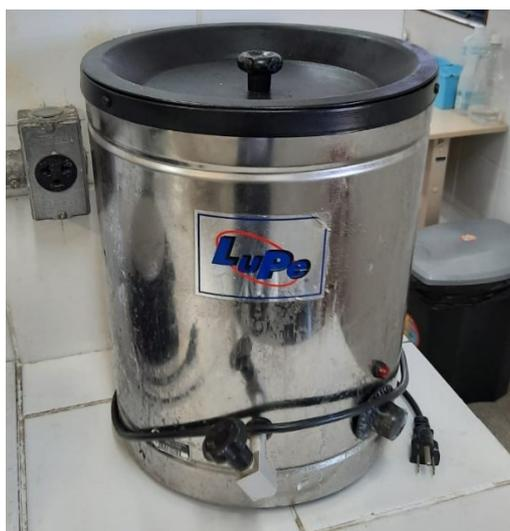
Figura 6: Dispensador de parafina. Equipamento no qual a parafina sólida (barra ou lentilha) é colocada para derreter e ser utilizada para encher os moldes de inclusão.
