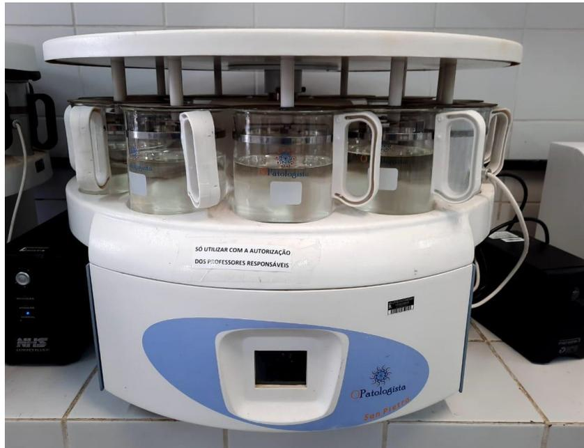
Figura 4: Equipamento histotécnico que realiza o processamento automático do tecido.
