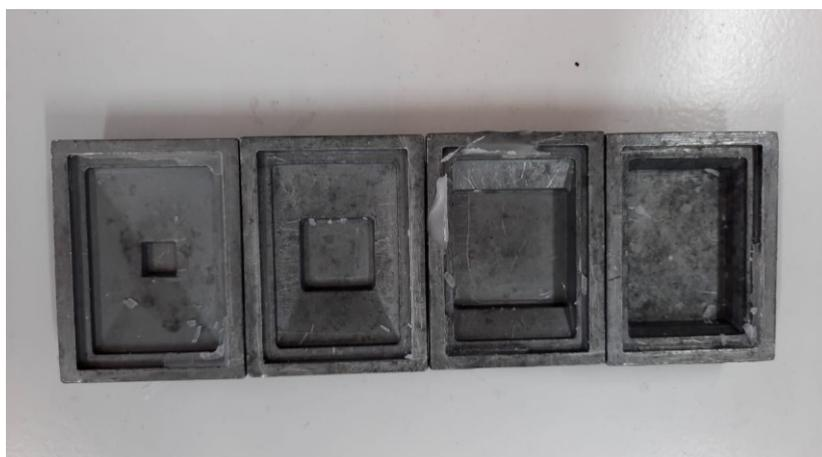
Figura 5: Molde de metal para inclusão do fragmento do material após a impregnação do tecido.
