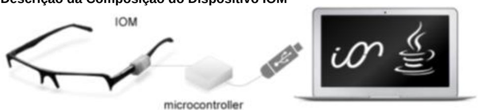
Figura 22 - Descrição da Composição do Dispositivo IOM
