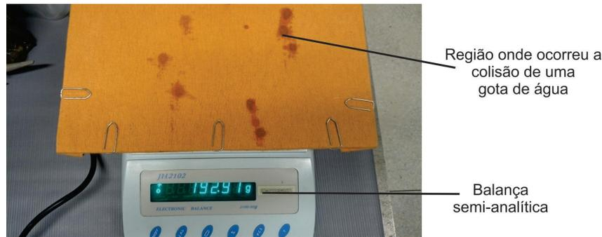
Figura 3.19: Medida da massa final  $m_f$ , após a colisão com dez gotas de água.
