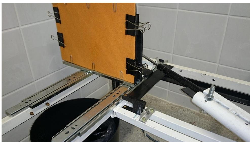
Figura D.3: Placa revestida com tecido presa aos trilhos.
