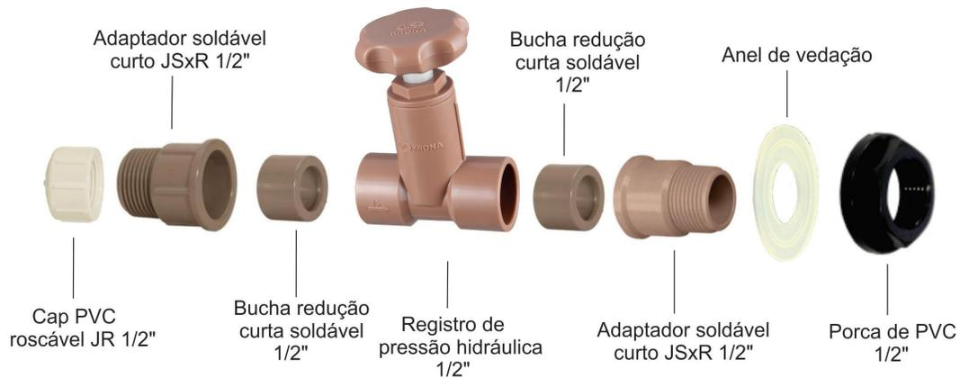
Figura 3.3: Perspectiva explodida do gotejador.
