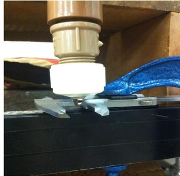
Figura 3.4: Montagem experimental para medição do diâmetro das gotas de água.
