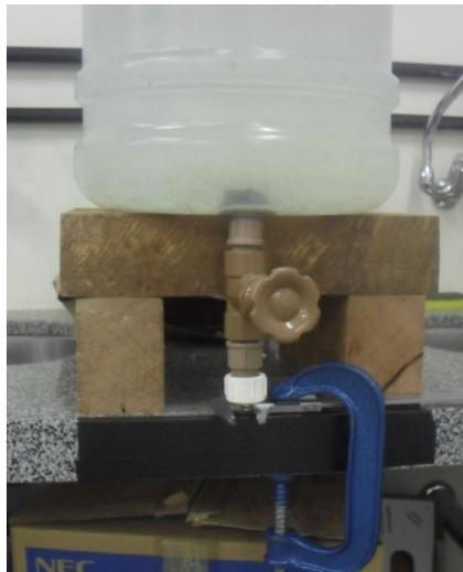
Figura 3.9: Montagem experimental para medição do diâmetros das gotas de água.
