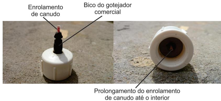
Figura 3.7: Versão final da cabeça do gotejador capaz de gerar gotas com 4 mm de diâmetro.
