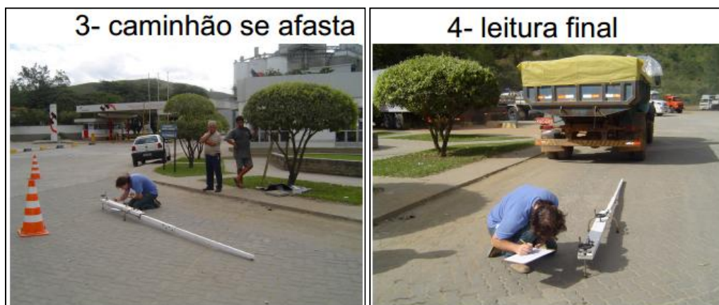
Figura 4 – Esquema Operacional da Viga Benkelman (Leitura final)
